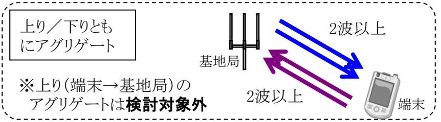
○ 基地局の**一の送信装置から複数の電波を発射**しアグリゲートする場合は、当該**送信装置内部での不要発射の増加が懸念** → **複数波の同時発射時の技術的条件を明確化**
