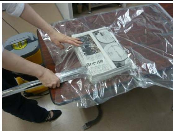
手順⑨：吸引により袋が内容物に張り付いたら、掃除機のスイッチを切らずにノズルを
