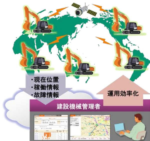
(例)センサーネットワークの活用による建築機械のモニタリングサービス
