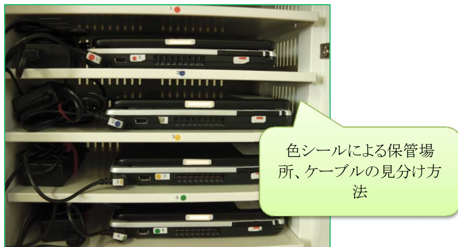
図. ACアダプタのケーブルの差し間違いの防止方法
