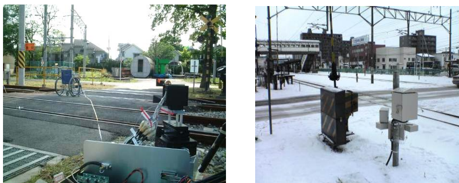
図 1.1-9 鉄道踏切障害物検知システム
