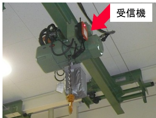
例) 小規模工場の天井クレーンを無線により遠隔操縦
