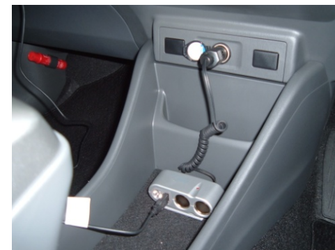
シガーソケットから電源確保
