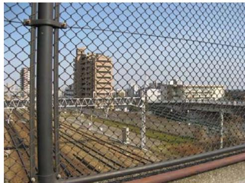
金網越し受信（金網孔寸法：高さ×横幅×一辺 40mm×42mm×31mm）
