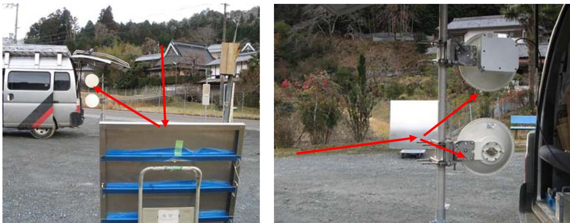
反射板：1 平方メートルのアルミ製
