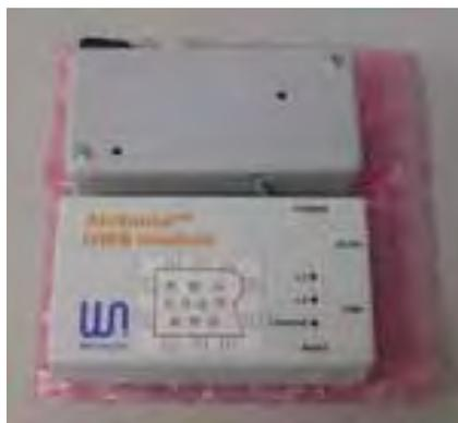
写真 4.1 センサー(写真上部)を装着したUWB端末
