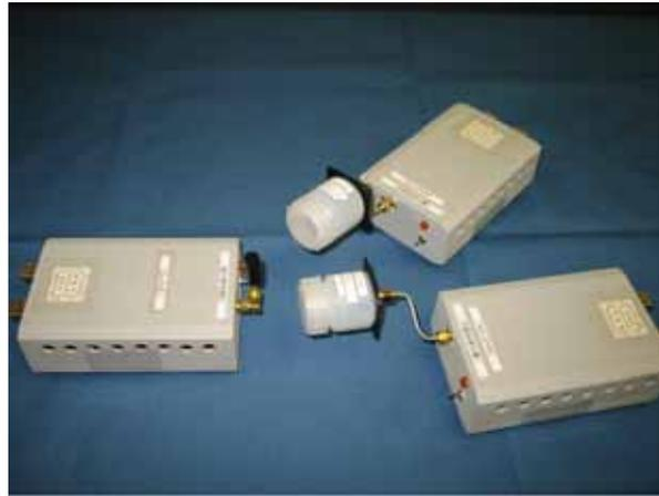
写真 2.1 ハイバンドUWB装置(左:移動機、右:固定機(2台))
