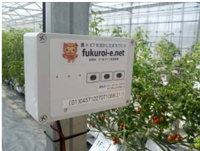
圃場内に設置した自立給電型マルチホップワイヤレスセンサー
