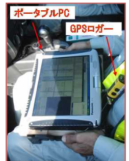
道路パトロール職員が用いるポータブルPC（左）とGPSロガー（右）
