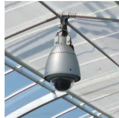
Webカメラ（左） 観光農園内に設置されたWebカメラによって、イチゴの生育環境を監視する。 ズーム比：18倍 ※EX光学ズームVGA 解像度使用時は36倍 デジタルズーム：最大12倍 水平回転範囲：0°~350° 垂直回転範囲：-30°~90°
