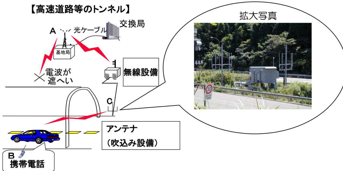
注：無線局Aと無線局Bとの間の電波が遮へいされるため、無線局Cを設置することにより代替する伝送路を開設。
