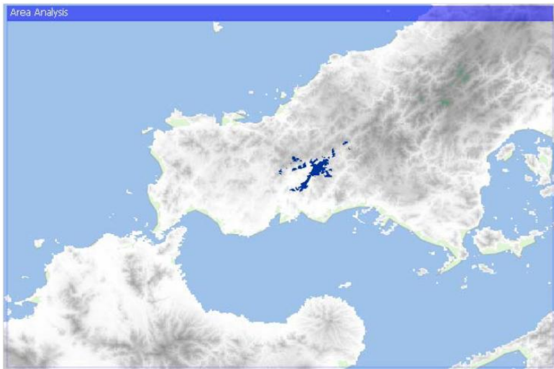
図 2. 5. 3-20 地球局 B : 同一チャネル干渉の結果 (小セル基地局、短時間干渉)
