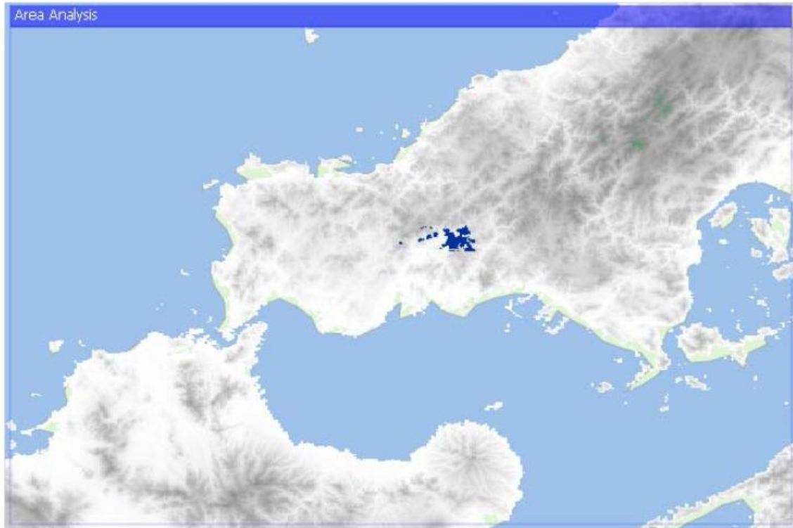
図 2. 5. 3-17 地球局 B : 隣接チャネル干渉の結果 (通常基地局、長時間干渉、45dBc の不要発射レベル)
