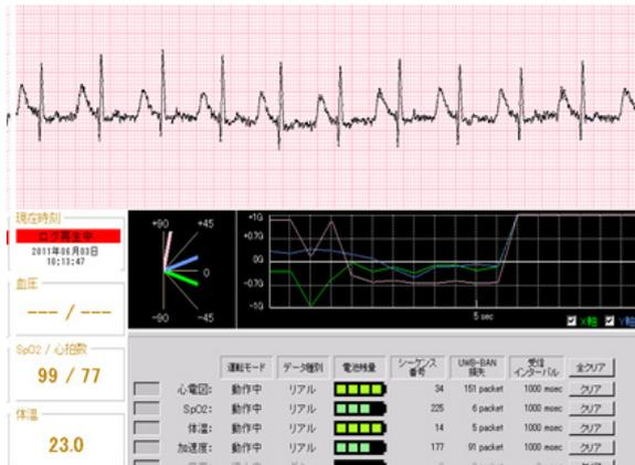
図 23 BAN コーディネータに接続されたバイタル情報（心電図,SPO2,体温等）表示系
