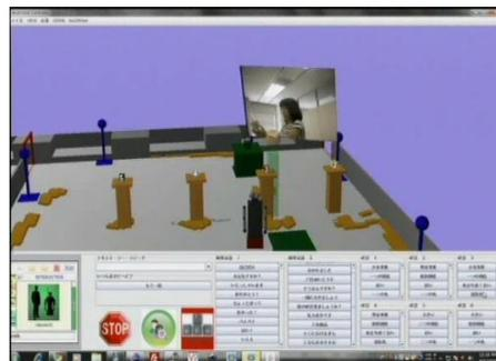
図2 ロボット操作に慣れていない管理者のためのインタフェース画面
