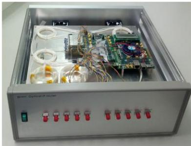
図3 バッファレス 光ルータ プロトタイプ
