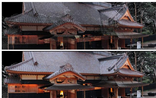
図 1. 既存手法と提案手法の処理結果の比較 (上図: 点群データの一般的な表示例, 下図: 提案手法による表示例)
