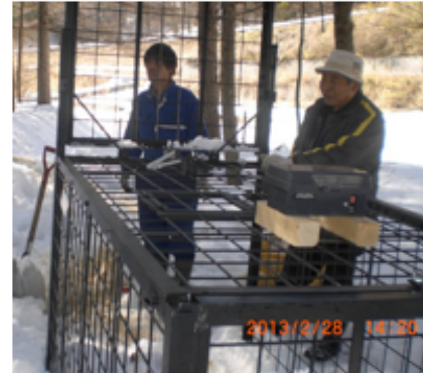
柵檻に接続したセンサー端末
