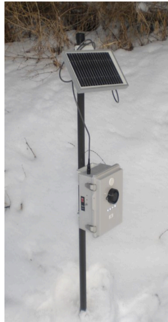
山中に設置したセンシングシステム 赤外センサーで関知
