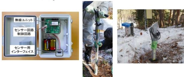
図2 センサー端末(左:回路小型化・測定点を10カ所へ増加)と土砂災害が懸念される山野への設置(中、右)
