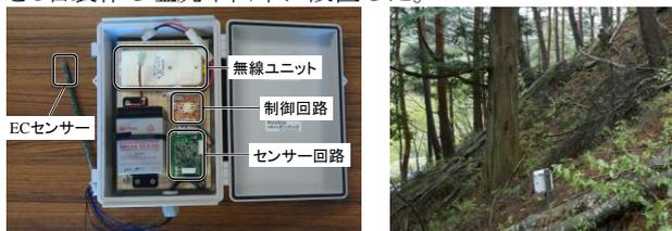
図1 平成23年度に作成したセンサー端末試作機(左)と土砂災害が懸念される山野への設置(右)
