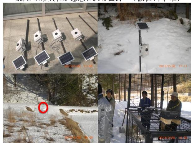
図3 鳥獣害センサー(左上)と設置状況(右上、左下)、及び、鳥獣捕獲用の柵檻に搭載したセンサー端末
