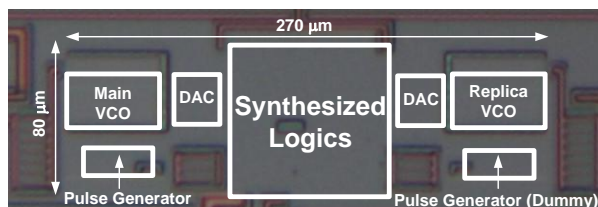
図5：提案する二重ループ型注入同期型PLL
