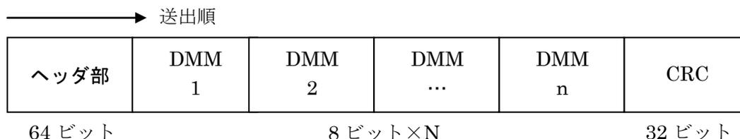
図 22 : DMM の構成
