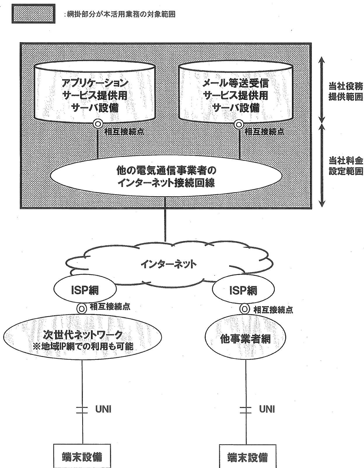
UNI(User-Network Interface)…ユーザ(端末機器)とネットワークを接続するためのインターフェース。
