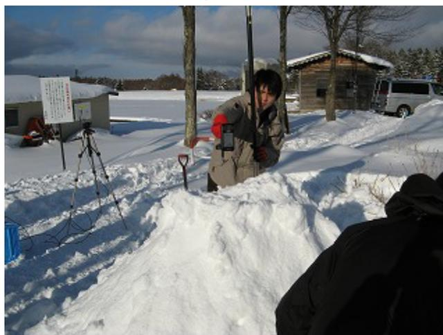
図 50 中出力での雪中 RF タグの読み取り
