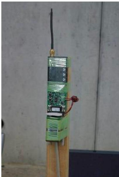
図 43 支柱の先端に取り付けたアクティブタグの受信機
