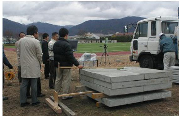
図 42 コンクリート(左:鉄筋無し、右:鉄筋有り)下に設置したアクティブタグ
