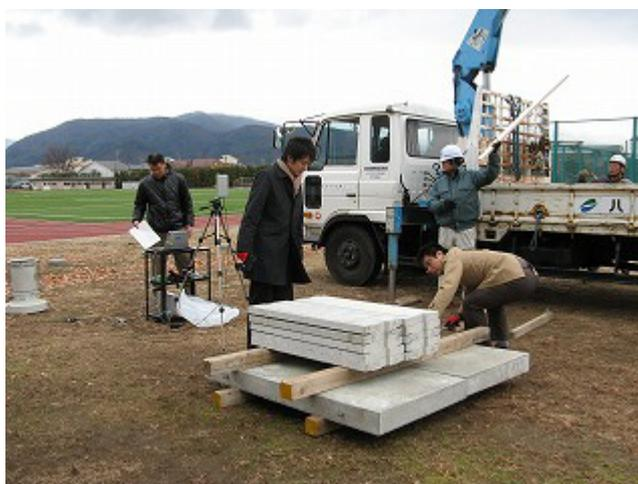
図 25 信州大学における障害物がある場合の電波伝搬実験
