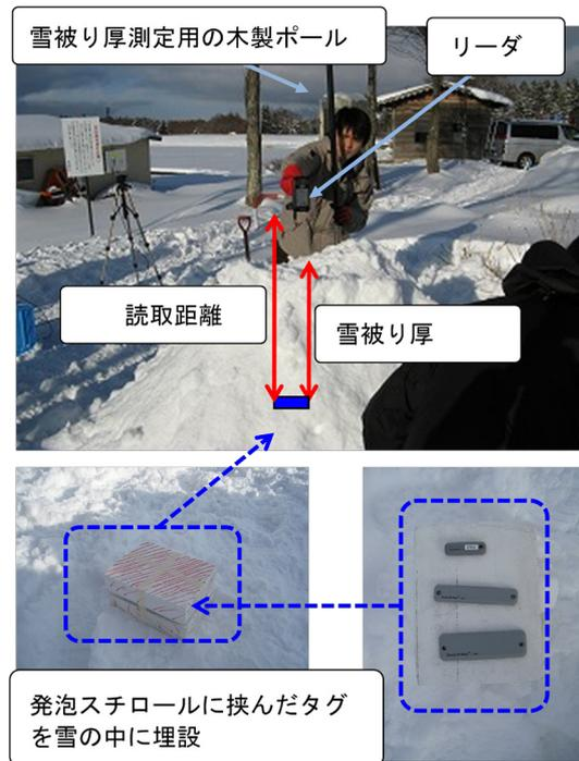
図 3-13 RF タグを雪に埋設し測定
