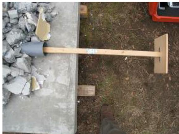
図 44 瓦礫下に設置したアクティブタグ
