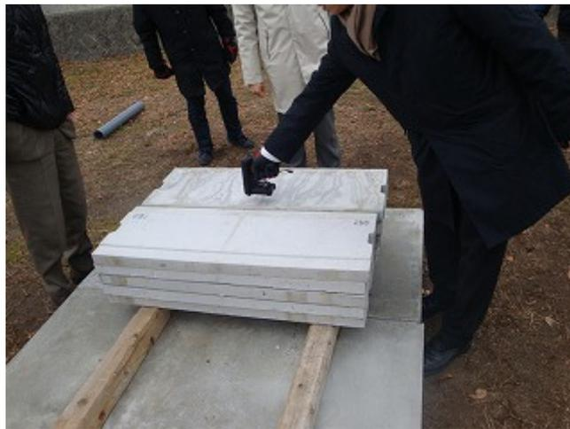
図 32 コンクリート板(鉄筋無し)を介した RF タグの読み取り実験
