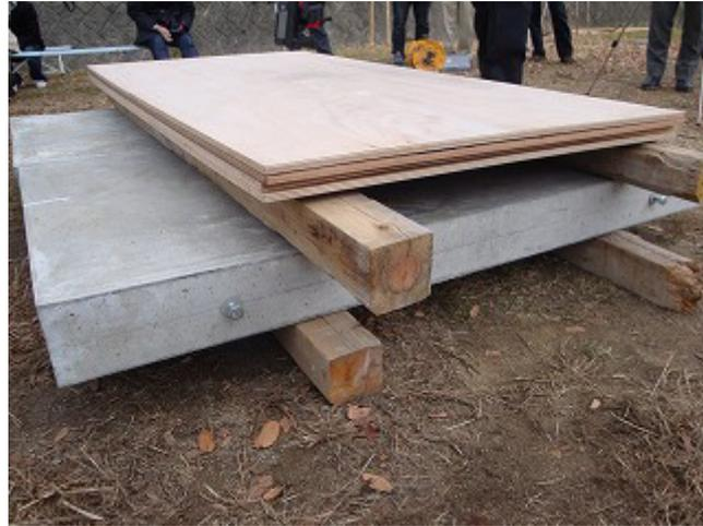
図 36 合板を介した RF タグの読み取り実験
