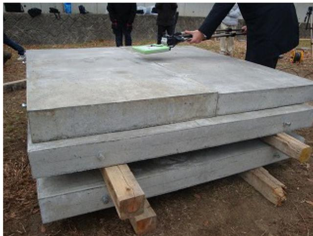
図 34 コンクリート板(鉄筋有り)を介した RF タグの読み取り実験
