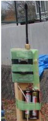
図 29 支柱先端のアクティブタグ
