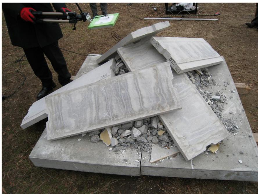
図 41 瓦礫で覆った上にコンクリート板(鉄筋無し)で不規則に覆った状態
