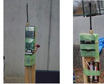
図 3-7 支柱の先端に取り付けたアクティブタグシステムの受信機(左)及び送信機(右)
