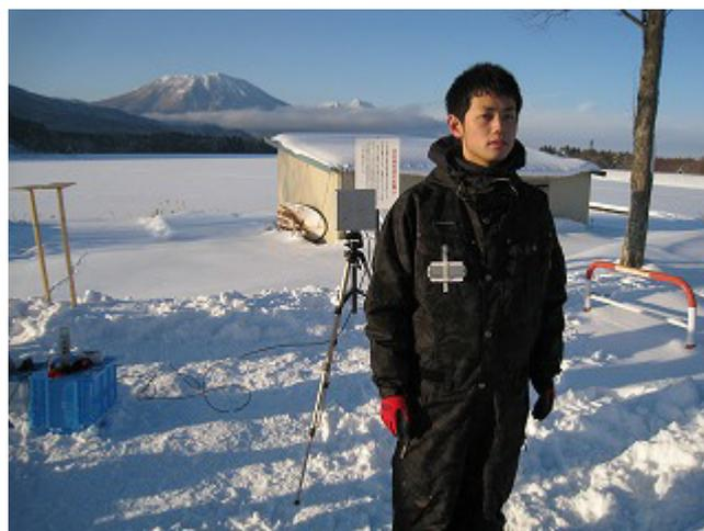
雪原での正面での読み取りでは 10m 離れた読み取りが可能であった。電波暗室で同様の実験では、同一の RF タグを使って最大 6.5m(人体との離隔 5cm)であった。電波暗室よりも地面の反射の影響などで電波が強められている可能性があり、読取距離は大幅に増加していた。
