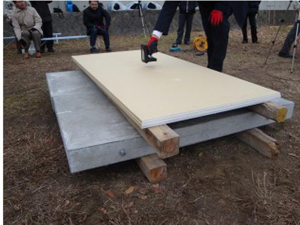
図 38 石膏ボードを介した RF タグの読み取り実験
