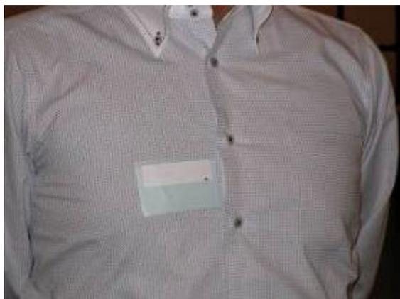
図 21 人体への RF タグの装着状況 直貼り
