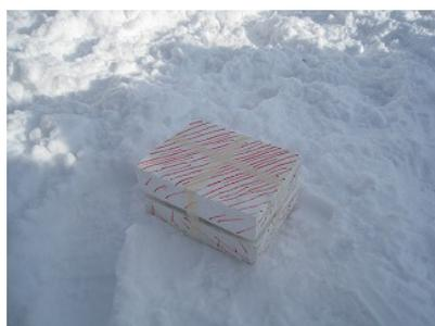
図 46 発泡スチロールで挟んだ RF タグ
