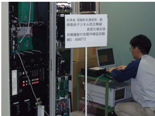
写真3.1 屋内検証試験の様子（基地局側設備）
