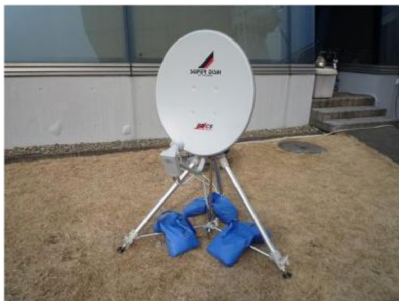
図 1.3.2.5.1 市販の衛星放送受信アンテナ外観
