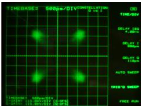
図 1.4.3.3.2-1 中継器シミュレータ折り返し QPSK 1/2 飽和点 OBO(OBO=0.9dB)
