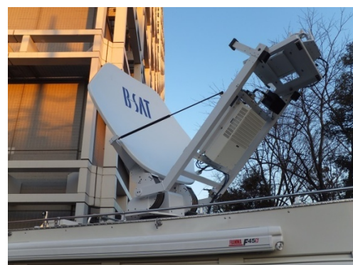
図 1.6.1 : 車載地球局外観、機器実装図観
