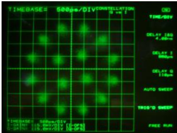
図 1. 4. 3. 3. 4. 5-1 中継器シミュレータ折り返し 16APSK 2/3 最適 OBO(OBO=1.8dB)
