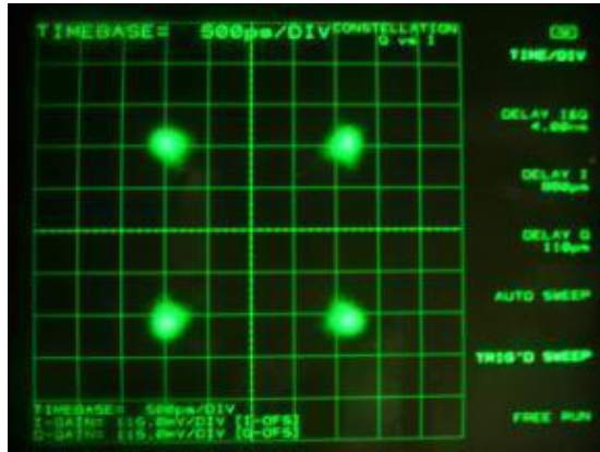
図 1.3.3.3.1-2 CS 衛星折り返し \pi/2 シフト BPSK 1/2
