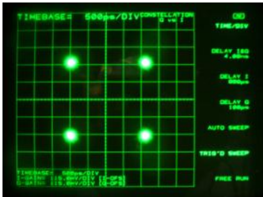
図 1.3.3.3.2-1 CS 地球局折り返し QPSK 1/2
