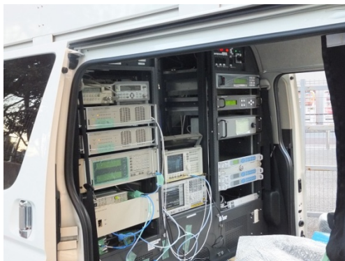
図 1.6.1 : 車載地球局外観、機器実装図観
