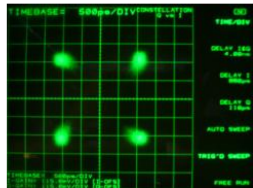
図 1.4.3.3.2-2 中継器シミュレータ折り返し QPSK 1/2 OBO=2.2dB
