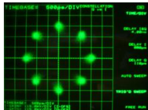
図 1.4.3.3.3-2 中継器シミュレータ折り返し 8PSK 3/4 OBO=2.2dB
