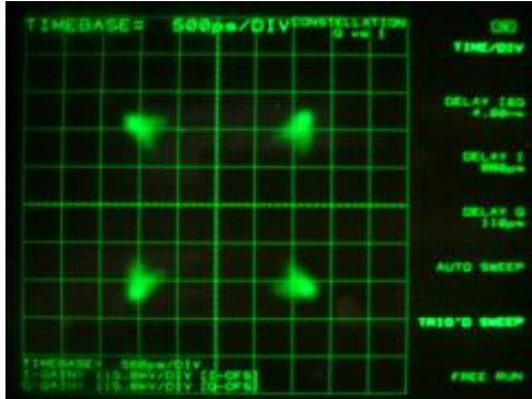
図 1.4.3.3.1-1 中継器シミュレータ折り返し \pi/2 シフト BPSK 1/2 飽和点 OBO(OBO=0.5dB)
