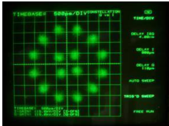
図 1. 3. 3. 3. 4. 3-2 CS 衛星折り返し 16APSK 1/2
