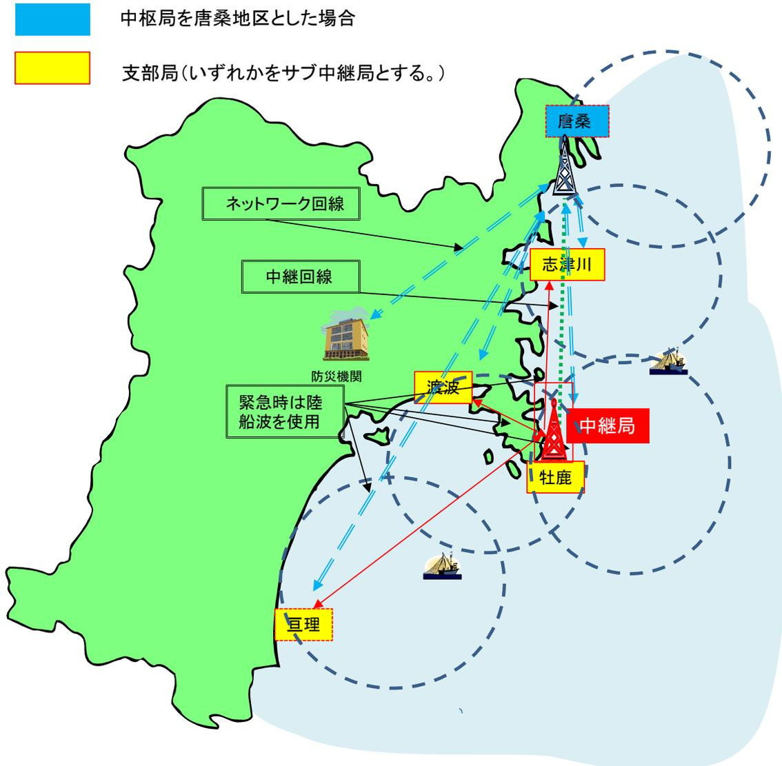
・中枢局を1か所に設置、通信エリアをカバーするために数か所設置。中枢局を置き、緊急時・非常時は統括局として運用。サブ中枢局として支部局の中から1局を選択
