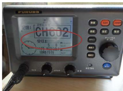
明瞭度 / 信号強度 (無線機 S メーターレベル) の測定
