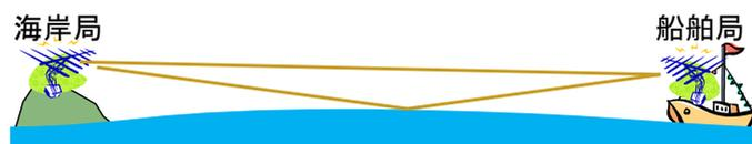
図 3-4 見通し距離内伝搬路: 直接波及び海面反射波
