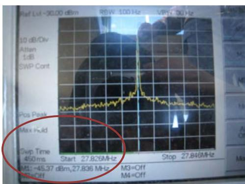
電界強度の測定 (max holdでの対象周波数に関する測定の例)
