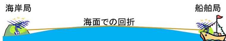
図 3-5 見通し距離外伝搬路(海面回折を含む)
