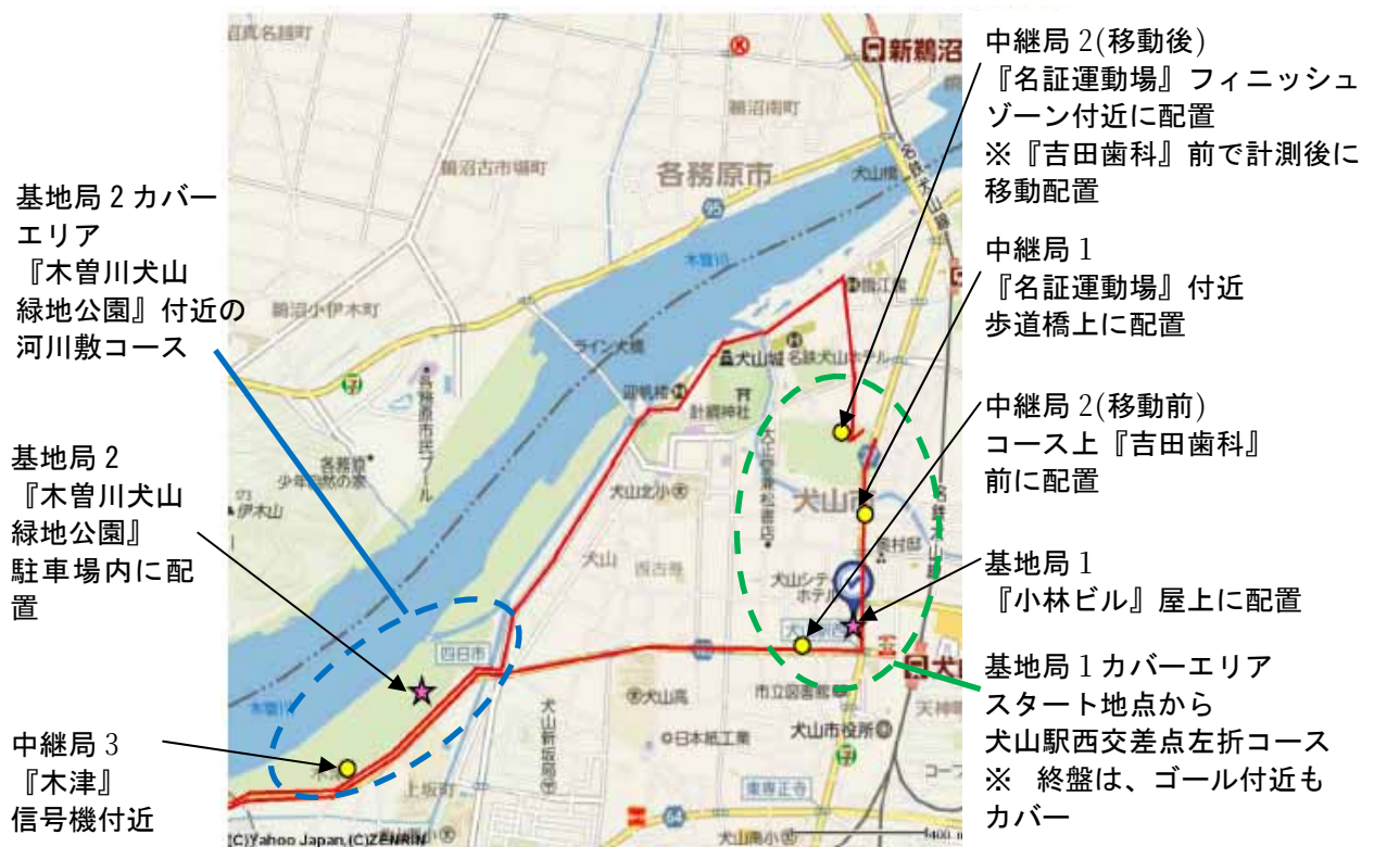
図 7.2.1-1 マラソンコース内の機器の設置位置
