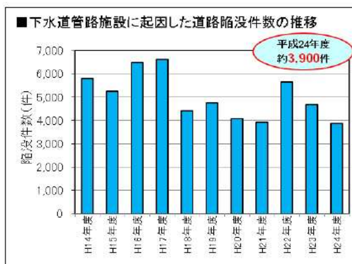
図表 II-6 下水道管路施設に起因した道路陥没件数の推移（国土交通省）
