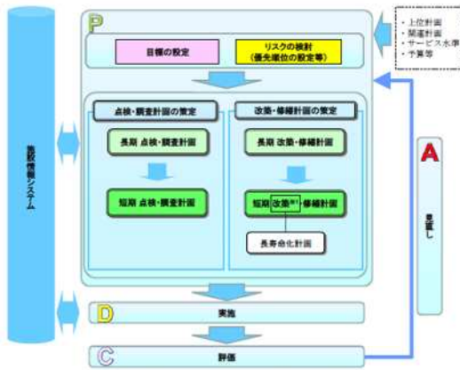
※1 短期改築・修繕計画のうち、短期改築計画が長寿命化計画に該当する。 図 1.2 Stockマネジメントを踏まえた長寿命化計画の策定
