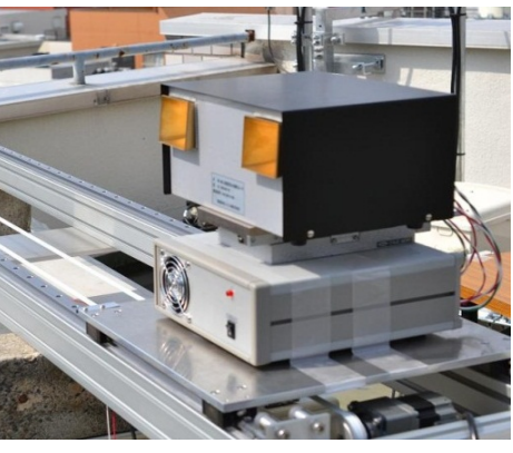
崖崩れの予兆現象や火山活動による地形の変動等の観測が可能な合成開口レーダー 【左:(株)BIT/上:キーコム(株)】
