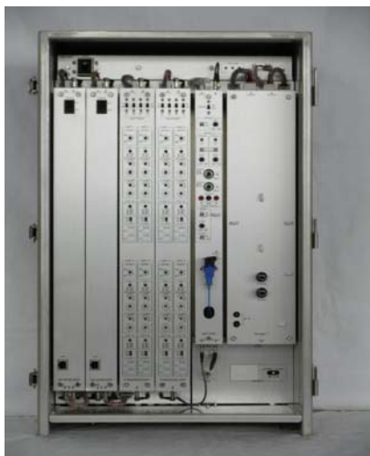
可搬型緊急用ヘッドエンド
