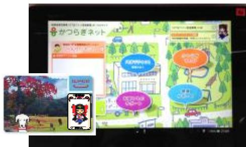
ICカードとタブレット端末(NFC対応)により、ワンタッチでシングルサインオン
