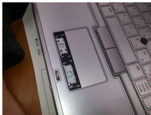
図 4.2-1 クリックボタンが外れたPC
