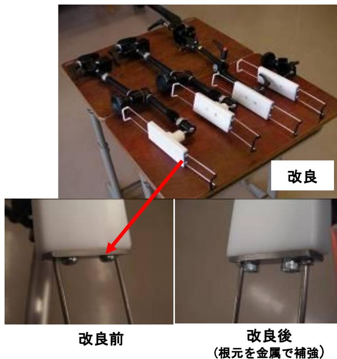
破損したワイヤー部分を補強したもの
