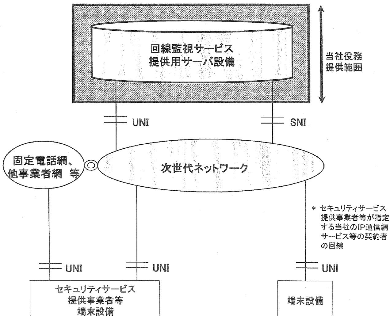
※UNI(User-Network Interface)…ユーザ(端末機器)とネットワークを接続するためのインターフェース。
