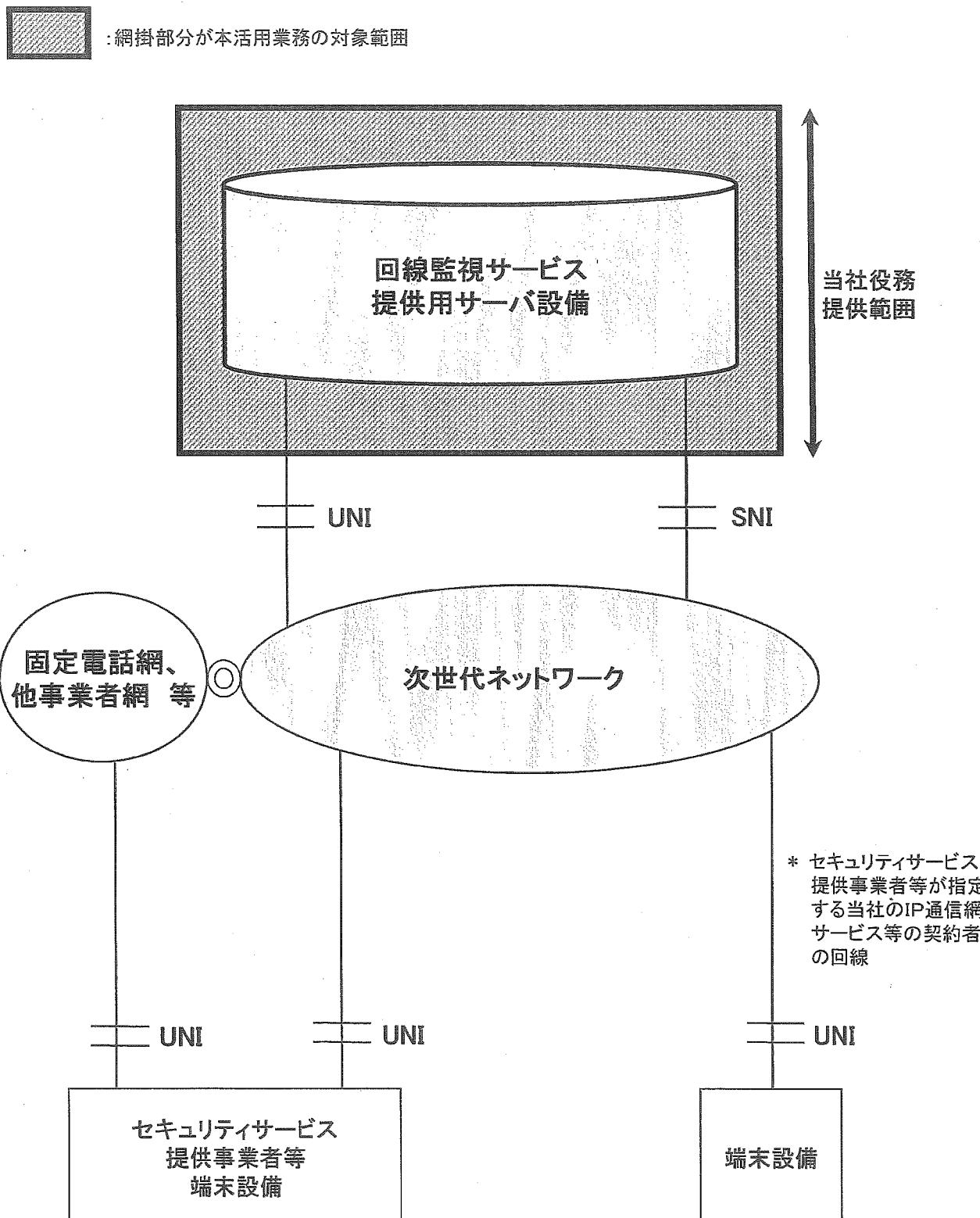
※UNI(User-Network Interface)…ユーザ(端末機器)とネットワークを接続するためのインターフェース。
