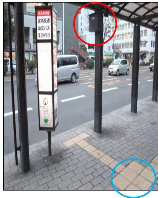
※ 上記画像の○部分（警告ブロック）の下にセンサーが埋設されている。また、上屋の○部分にスピーカーが設置されている。
