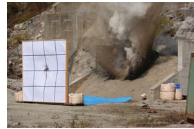
図：はやぶさ2衝突装置 飛翔性能確認試験衝突装置から射出される飛翔体について、命中精度等所定の機能実証が得られた。
