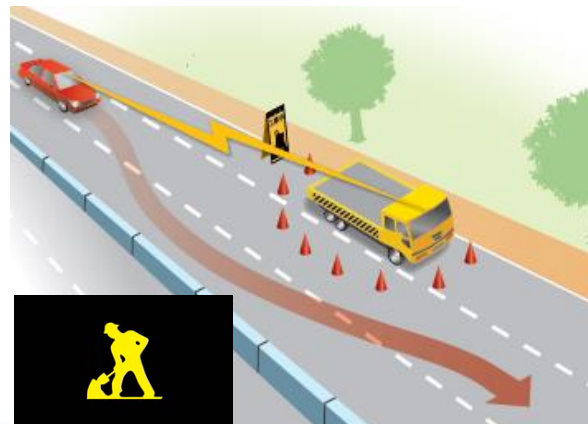
工事車両情報提供システム
