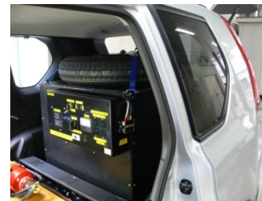
【発電機操作盤】
