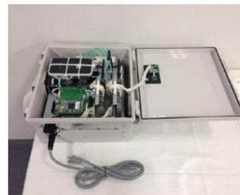
Wi-SUN基地局には転倒センサーへの通信機能、監視カメラ、雨量計、温湿度計を搭載。
