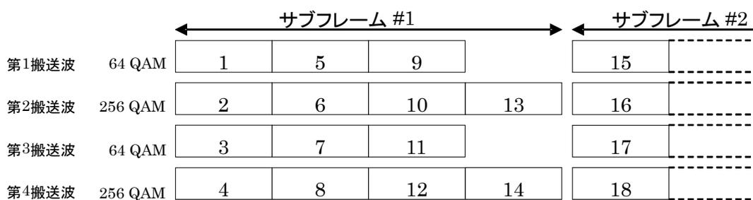
図 4.7-4 搬送波群に属する搬送波の変調方式が異なる場合のスロットの配列順 (メモリ空間)
