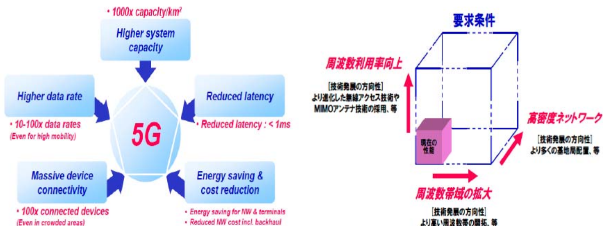
図表 1－3－4 第5世代移動通信システムの要求条件 38
