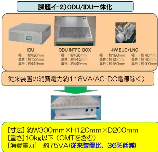
図 14 ODU/IDU の一体型地球局
