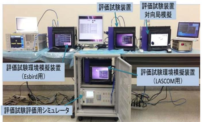
図 5 室内での試験評価環境
