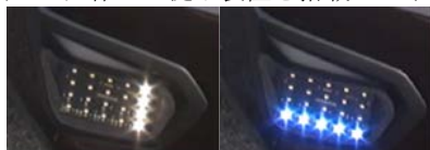
図4 運転者状態表示例 (左: 注意方向、右: 運転者状態低下 (実際には点滅表示))
