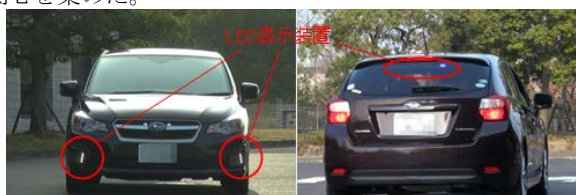
図3 試作した提示装置を搭載した車両
