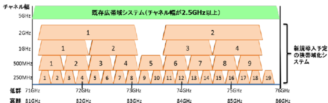
図 2-2 狭帯域システム制度化初期のチャンネル配置案
