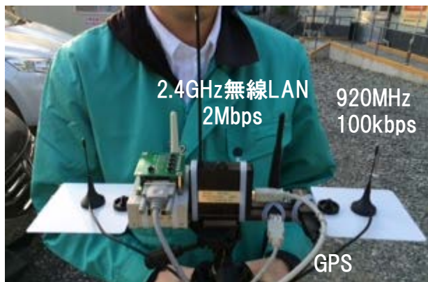
三脚に固定した各無線装置のアンテナ
