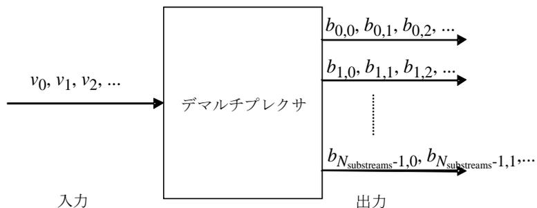
ビットインターリーブからのビットストリーム  $v_i$  は、上図に示すようにデマルチプレクスされ、 $N_{\text{substreams}}$  個のサブストリームに変換される。 $N_{\text{substreams}}$  の値は下表の通り。
