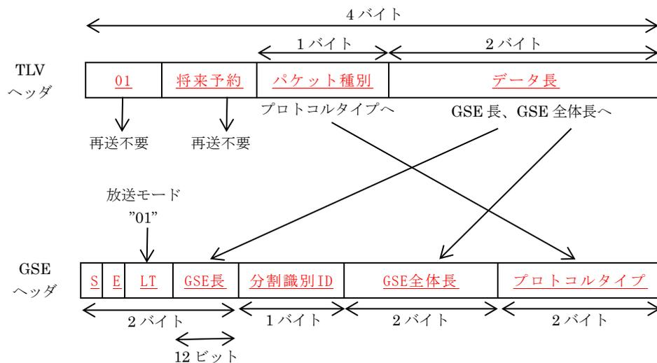
注1 Sは開始インジケータを表す1ビットであり'1'はGSEパケットの開始とベースバンドフレーム完了を表す。
