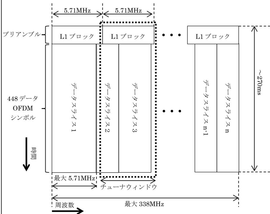
第 2 世代有線システムの搬送波の伝送帯域の構成
