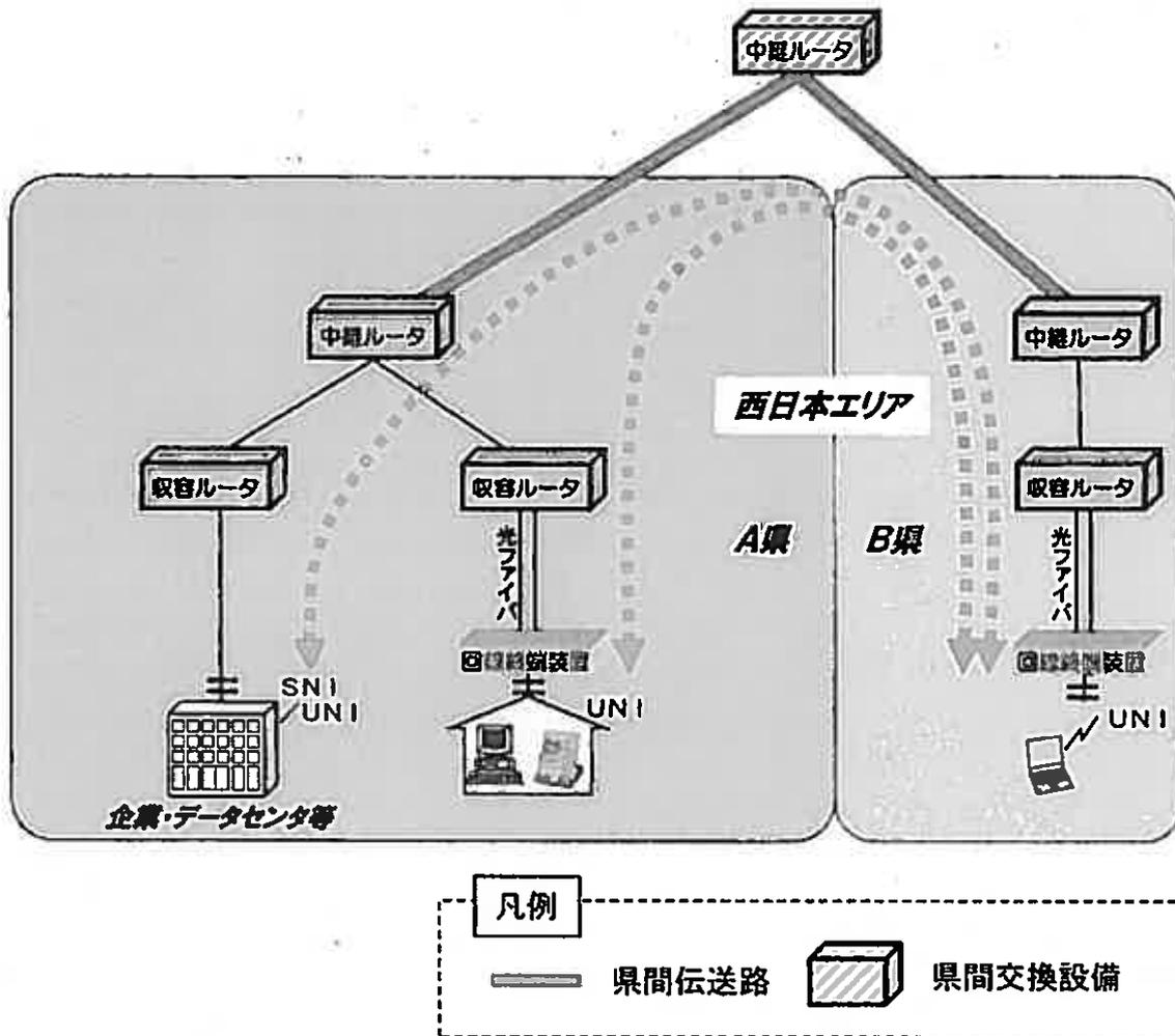
※ SNI(Application Server-Network Interface)・・・各種アプリケーションサーバ類とネットワークを接続するためのインタフェース。
