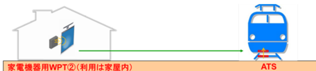
図 3.3.2-1 家電機器用 WPT システム と信号保安設備の干渉検討モデル
