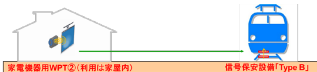
図 3.3.2-4 家電機器用 WPT システム と信号保安設備の干渉検討モデル
