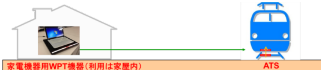
図 3.3.3-1 家電機器用 WPT システム と信号保安設備の干渉検討モデル
