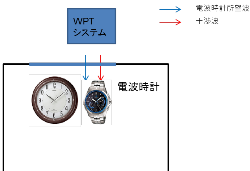
図 3.2.1-1 電気自動車用 WPT システムと電波時計の干渉検討モデル
