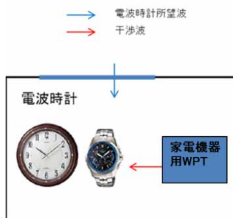
図 3.2.2-1 家電機器用 WPT システム の設置モデル（同一家屋）
